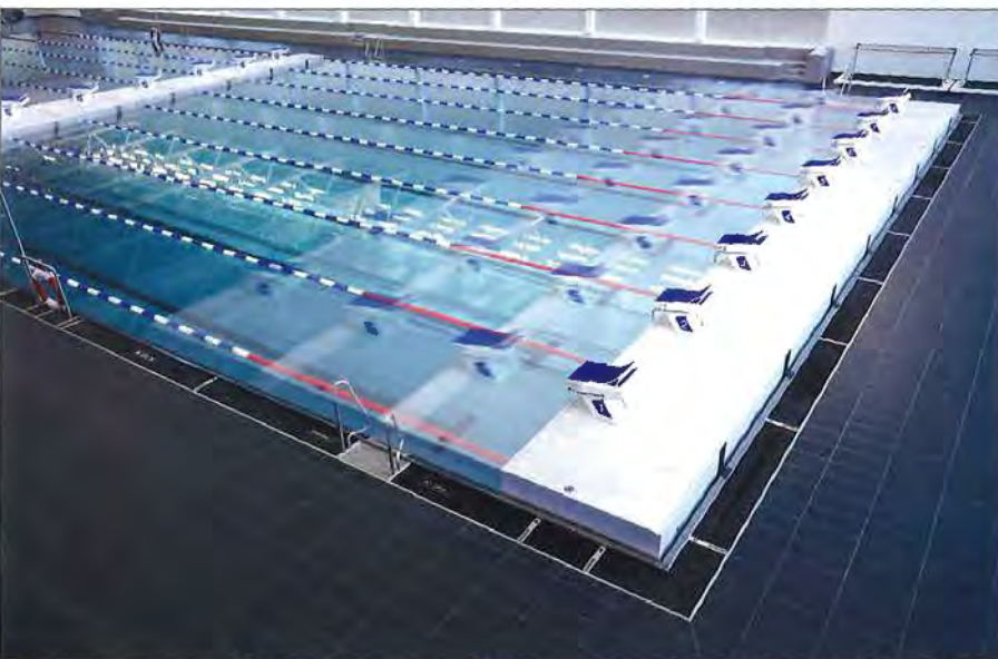
■ ... die verfahrbare Startbrücke
