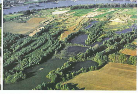
28 An der niederländischen Grensmaas werden Hochwasserschutz und Rohstoffabbau verknüpft. Im Bild: Tonabgrabungen als Überschwemmungsflächen.
