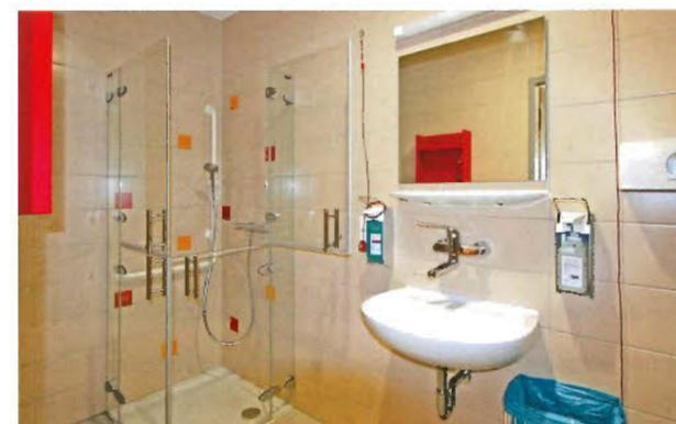
Sanitärraum - hier sind Duschen mit horizontal geteilten Kabinen eingebaut. So kann die pflegende Person eingreifen, ohne nass zu werden.
